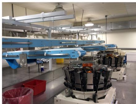
Les convoyeurs DynaClean® sont idéaux pour les installations de transformation des aliments. Construits à partir d'une variété de maillons en plastique ou de courroie à surface solide ThermoDrive, ils sont faciles à nettoyer.
