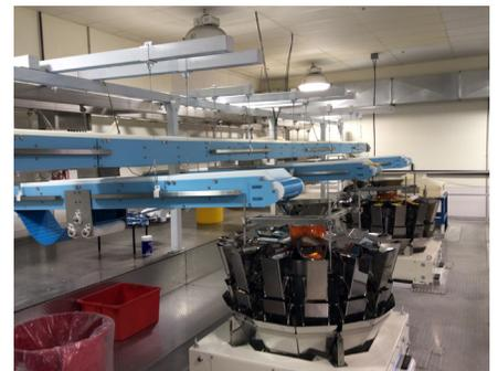
Los transportadores DynaClean<sup>®</sup> son ideales para instalaciones de procesamiento de alimentos. Su construcción a partir de correas de superficie sólida ThermoDrive o eslabones de plástico facilita la limpieza.
