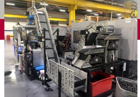
Convoyeur modulaire avec kit de confinement de pièces, goulotte et trémie et moteur sans balais à haut rendement.
