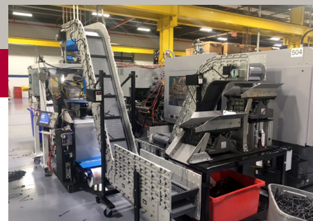
Transportador modular con kit de contención de piezas, conductos y contenedores, y motor de alta eficiencia sin escobillas.
