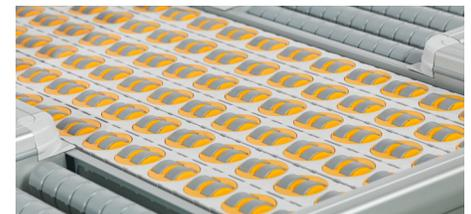
Unidad de transferencia omnidireccional, izquierda, derecha y a través.
