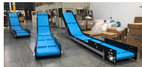
Correa de alto impacto con paredes laterales continuas y resistencia a la abrasión.
